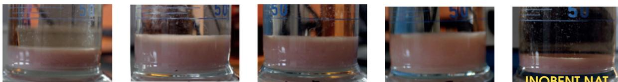
Уплотнение осадка при использовании INOVENT NAT и других коммерческих образцов бентонита
